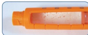
沈殿物が生じた例
